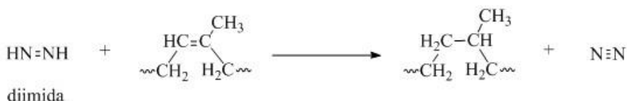
Rajah 1. Skema tindak balas penghidrogenan ke atas LNR melalui termolisis TSH
